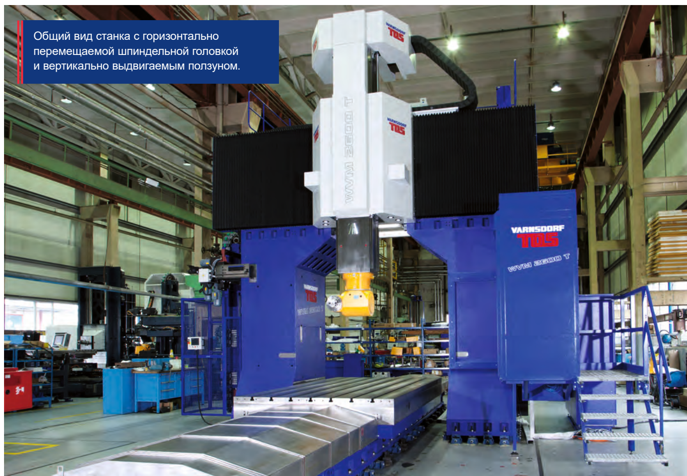
Вид на ортогональную 2-х осевую, автоматически индексируемую фрезерную головку.
