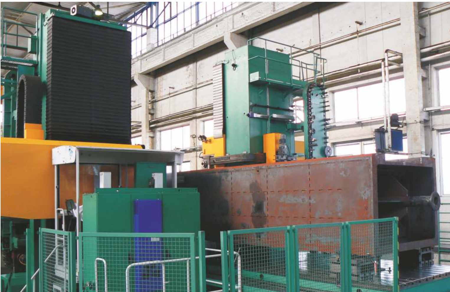
TOSTec PRIMA (nahoe) a stojan WRD 170 naložený na upínací desce stroje WRD 150 DUO (dole).
