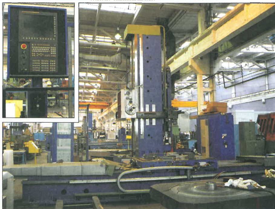
Zdánlivě běžná třináctka WHQ 13 CNC v.č. 2902. V detailu vidíte nový systém FANUC.
