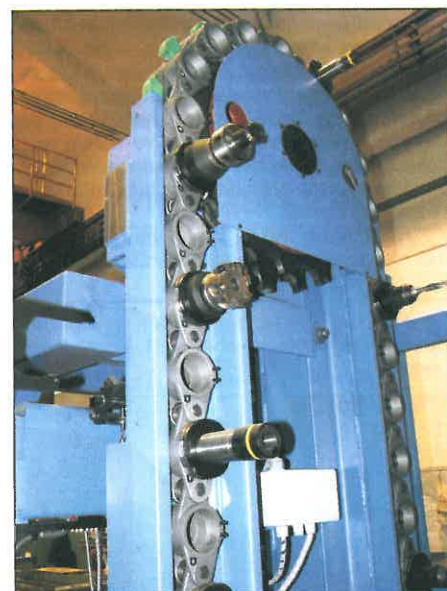
Článkem zmíněná novinka - hliníkové provedení úložných míst řetězového zásobníku nástrojů.
