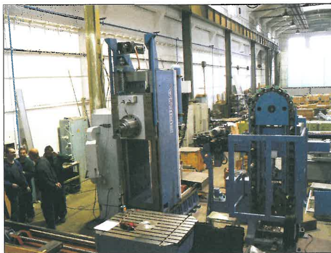
Tak jsme viděli výstavní stroj PRIMA v. č. 0108 ve středu 30. srpna, když ještě byl sestaven na ploše montáže DMG, kde právě probíhalo měření geometrie.
