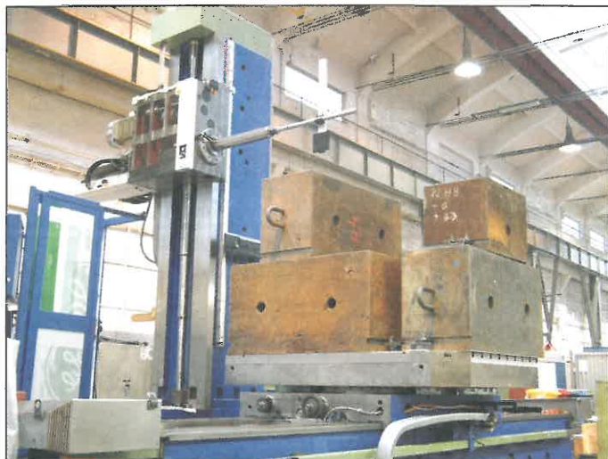
Obrazem se vracíme ke zprávě z předminulého čísla. V minulém týdnu probíhaly zátěžové zkoušky nového dvacetitunového stolu na inovované verzi stroje WHQ 13 CNC.
