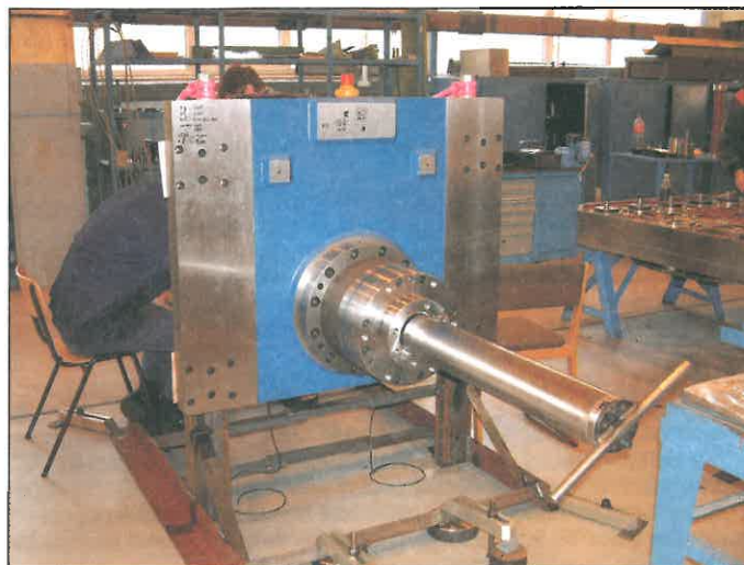
Na tomto snímku vidíte detail ze zákulisí montáže stroje TOStec VARIA, je to vřeteníková deska s výsuvným vřetenem.
