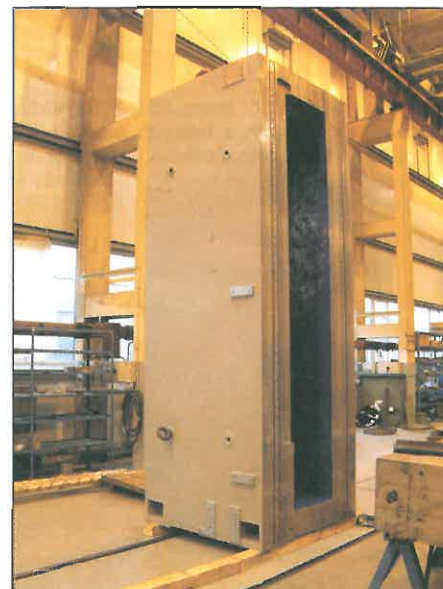
Další detail stavěného stroje TOStec VARIA - stojan (osa Y u tohoto stroje v.č. 0103 je 2.500 mm, stroj pocestuje do Švýcarska).
