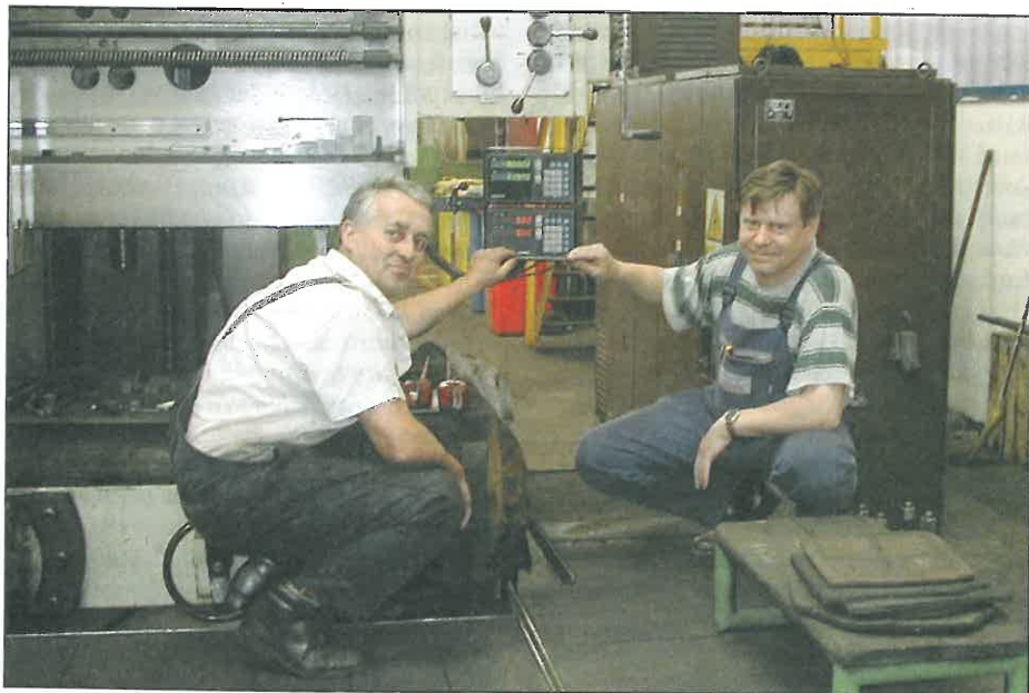
Zásluhou pana Goly (vpravo) byla v krátkém čase realizována modernizace hoblíku H25 2x8 ve středisku Těžká mechanika aplikací odměňování Sony pro vertikální polohování suportů. Rozlišovací schopnost snímače je v setinách milimetru a umožňuje obsluhu kvalitnější obrábění.
