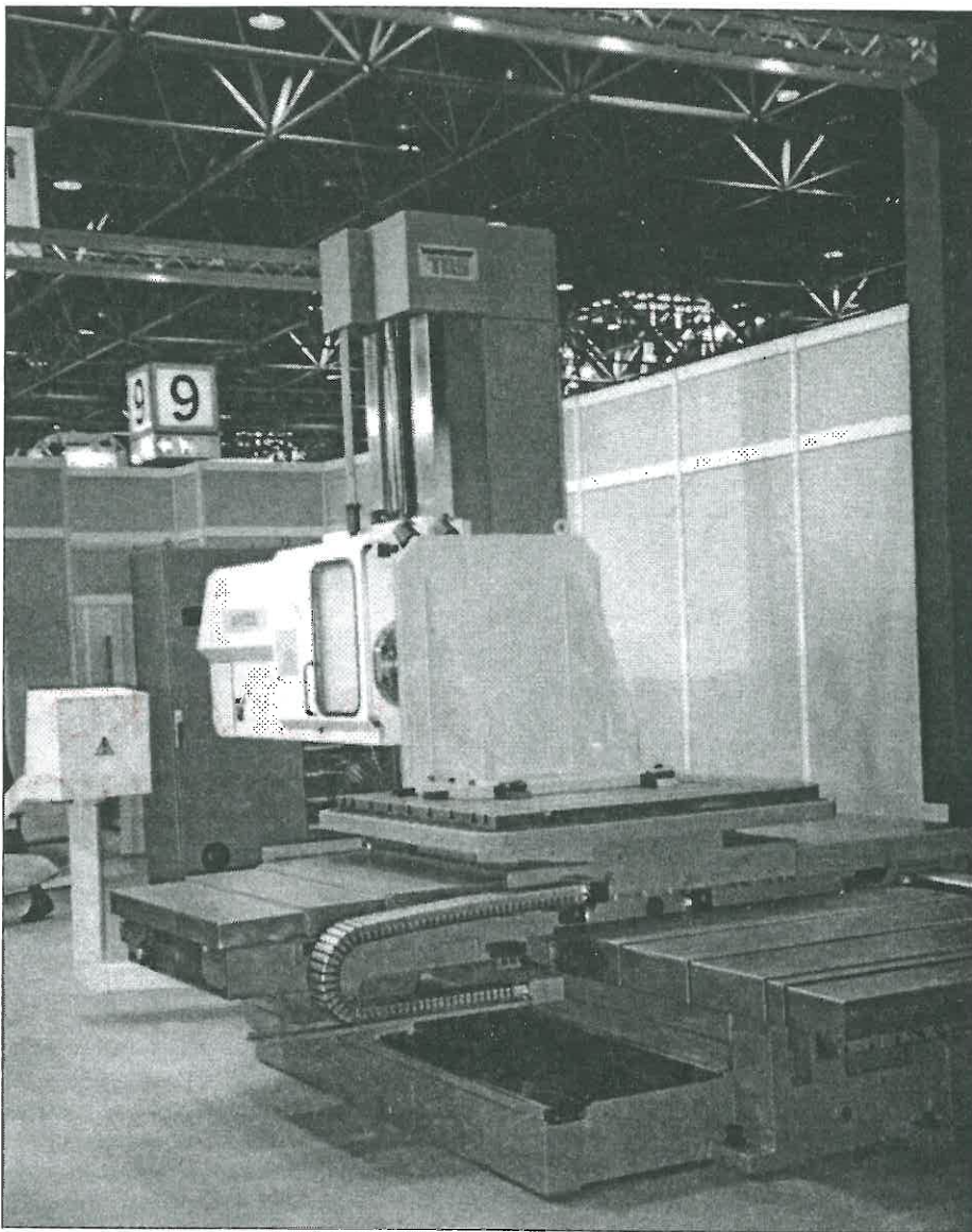
Náš exponát - vodorovná vyvrtávačka WH 105 s číslicovou indikací - na výstavě METAV 1998.
